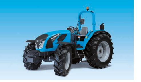
Die Traktoren 5D-T4i stellen eine Weiterentwicklung der Modellreihe Powerfarm dar und stehen in drei Modellen im Leistungsbereich von 85 bis 102 PS zur Auswahl: 90, 100 und 110.
