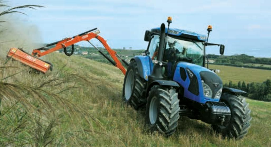
La nuova Serie 6C Landini nasce come erede della gamma *Powermondial*. Disponibile nei tre modelli da 114, 121 e 130 CV, la gamma è stata motorizzata con i nuovi motori FPT NEF (*Tier 4 Interim*) da 4,5 litri, dotati dell'innovativo sistema S.C.R. *Selective Catalytic Reduction* per ridurre le emissioni allo scarico. Grazie al sistema *Dual Power* il motore può erogare fino a 121, 133 e 140 CV alla Presa di forza e in trasporto.
