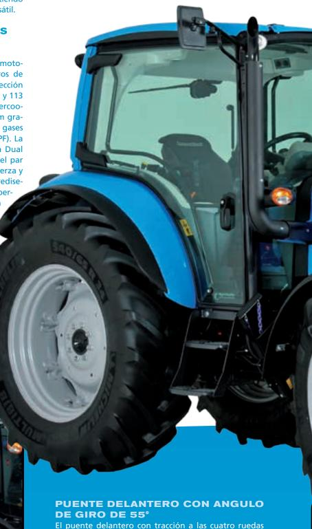
El puente delantero con tracción a las cuatro ruedas de conexión electrohidráulica y ángulo de giro de 55° garantiza una excelente distancia libre hasta el suelo y una maniobrabilidad óptima. La acción combinada de los frenos de discos en baño de aceite delanteros y traseros garantiza un frenado óptimo en las cuatro ruedas. El diferencial con bloqueo total de accionamiento electrohidráulico proporciona máxima tracción incluso en los terrenos más difíciles (fig. B).
