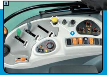
HYDRA-PTO: TOMA DE FUERZA DE 2 O 3 VELOCIDADES CON MANDO HIDRAULICO PARA UNA FLEXIBILIDAD OPTIMA
