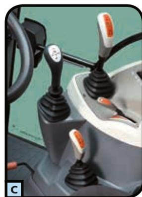
La Serie 4 dispone di un cambio base (*Speed Four*) modulare e versatile che è basato su 4 marce sincronizzate con tre gamme meccaniche per ottenere 12 AV+12 RM. La trasmissione viene offerta a 30 km/h, per i trattori a 2RM, con l'aggiunta del superriduttore per 16+16 velocità. Nei trattori a 4RM al cambio base si può associare il *Power Four* (mezza marcia idraulica HI-LO con riduzione o incremento di velocità del 18%, per 24AV+24RM a 40 km/h).
