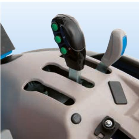
Der mechanische Heckkraftheber mit Dreipunktgestänge der Kategorie 2 bietet eine Hubkraft von bis zu 3250 kg und verfügt über die Bedienfunktionen Lage-, Zugkraft- und Mischregelung sowie Schwimmstellung. Für höhere Vielseitigkeit kann der **REX4** mit einem Frontkraftheber und einer 1000er Frontzapfwelle ausgerüstet werden. Der Kraftheber der Kategorie 2 bietet eine Hubkraft von 1400 kg.
