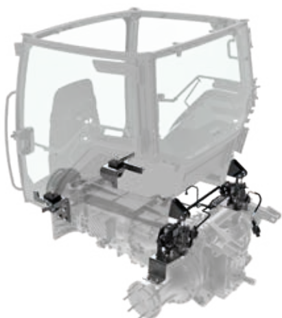
● Semi-aktive hydraulische Kabinenfederung
