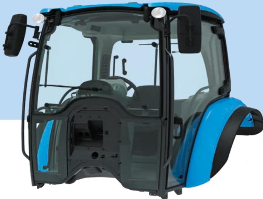
per garantire la massima sicurezza, tramite prove FOPS (Falling Objects Protecting Structure) la cabina è stata omologata per l'utilizzo di caricatori frontali.
