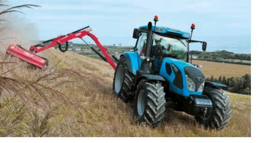
Die neue Serie 6C beinhaltet drei Modelle mit 114, 121 und 130 PS, die von FPT-NEF-Motoren mit 4,5 Litern Hubraum angetrieben werden. Diese Antriebsaggregate erfüllen die Abgasnorm Tier4 Final durch ein Abgasreinigungssystem, das einen SCR-Katalysator (Selektive Katalytische Reduktion) mit einem Dieseloxydationskatalysator (DOC) kombiniert.
