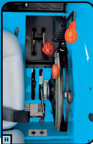
**HIDRAULICO PARA ELEVADOR Y DISTRIBUIDORES AUXILIARES**
