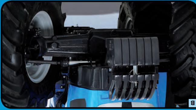
El puente delantero con tracción a las ruedas de conexión eléctrohidráulica proporciona un ángulo de giro de 55° garantizando una excelente distancia libre hasta el suelo y una maniobrabilidad óptima (fig. B). El bloqueo de diferencial de deslizamiento limitado asegura la máxima tracción incluido en los terrenos más difíciles.
