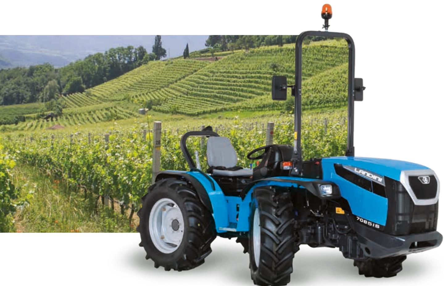
appuyant tout simplement sur un bouton-poussoir. La gamme comporte de série une transmission 16/16 avec inverseur mécanique et super-réducteur.
