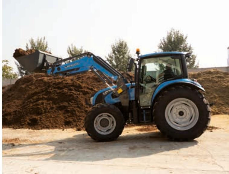
inverseur mécanique ou hydraulique, et d'une installation hydraulique puissante de 60 l/min. Le relevage arrière est contrôlable par le ELS (Ergonomic Lift System) et il offre une capacité de levage de 4 500 kg.
