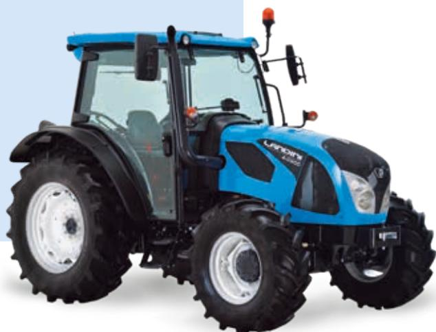
gammes et dispose d'un inverseur mécanique donnant 12 vitesses avant et 12 vitesses arrière. Le tracteur peut être équipé, en option, d'un superréducteur donnant au total 16 rapports en marche avant et 16 en marche arrière et permettant d'atteindre une vitesse minimale de 300 m/h.
