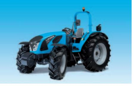
La gama de tractores Landini se amplía con la nueva serie 5D-T4i, que representa la evolución de la exitosa serie Powerfarm. La nueva familia se compone de tres modelos: 90, 100 y 110, que abarcan potencias de 85 a 102 CV y equipan los motores Perkins 854E-E34TA T*ier 4 Interim*.
