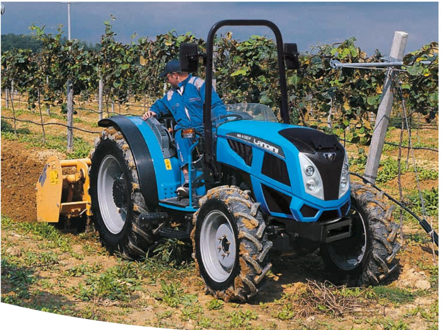
conducción espacioso y ergonómico con mandos dispuestos de forma intuitiva y racional para ofrecer al conductor el máximo confort y facilidad de manejo. Los tractores **REX4** están disponibles con tres opciones de transmisión y varias configuraciones de eje delantero y trasero con diferentes anchos de vía y distancias entre ejes.
