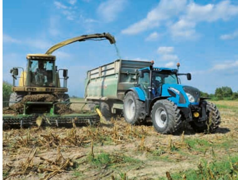
dad de marcha comparable a la de una transmisión de variación continua. El caudal del circuito hidráulico se ha incrementado hasta los 160 l/min, permitiendo accionar un elevador trasero con capacidad de elevación de 9300 kg y hasta 7 distribuidores auxiliares. La **Serie 7** se ofrece en dos niveles de equipamiento: una versión Active, y una versión de alta gama, Dynamic.
