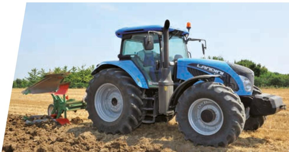
Als Nachfolger der erfolgreichen Landpower-Baureihe kommt die Serie 6L in drei Modellen auf den europäischen Markt: Das 6-145L mit 143 PS, das 6-160L mit 163 PS und das 6-175L mit 176 PS. Die Traktoren Serie 6L werden von 4,5-Liter-Motoren mit 16-Ventil-Technik und SCR-Abgasreinigungssystem, die die Emissionsvorschriften entsprechend Tier 4 Interim erfüllen.
