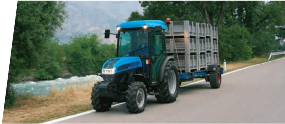
Bei der Baureihe Rex S/V handelt es sich um innovative Schlepper, die speziell für Wein- und Obstbau in engen Kulturen konzipiert wurden. Die Traktoren der Serie Rex werden in zwei Modellen angeboten: V für Weinbau und S für Obstanlagen mit engem Reihenabstand. Sie zeichnen sich durch äußerst kompakte Abmessungen aus und sind mit einer neu gestalteten, abgerundeten Motorhaube und einem klappbaren Überrollbügel in der Plattformversion ausgestattet.
