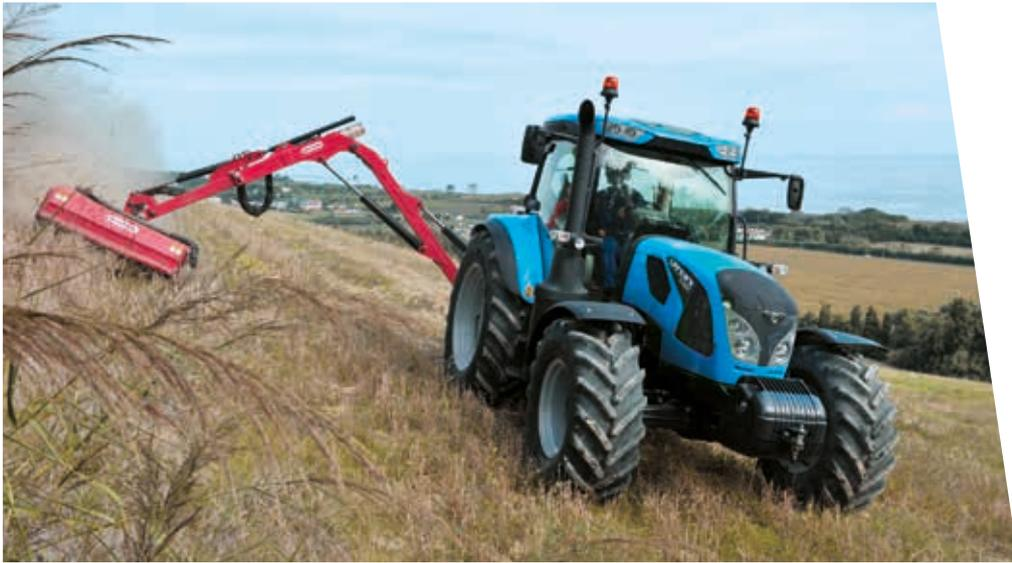
Die drei Modelle der Baureihe 6C mit 114, 121 und 130 PS werden von den leistungsstarken FPT-NEF-Motoren mit 4,5 Litern Hubraum angetrieben. Diese Antriebsaggregate verfügen über das innovative SCR-Abgasreinigungssystem und erfüllen die Abgasnorm gemäß Tier 4 Interim.
