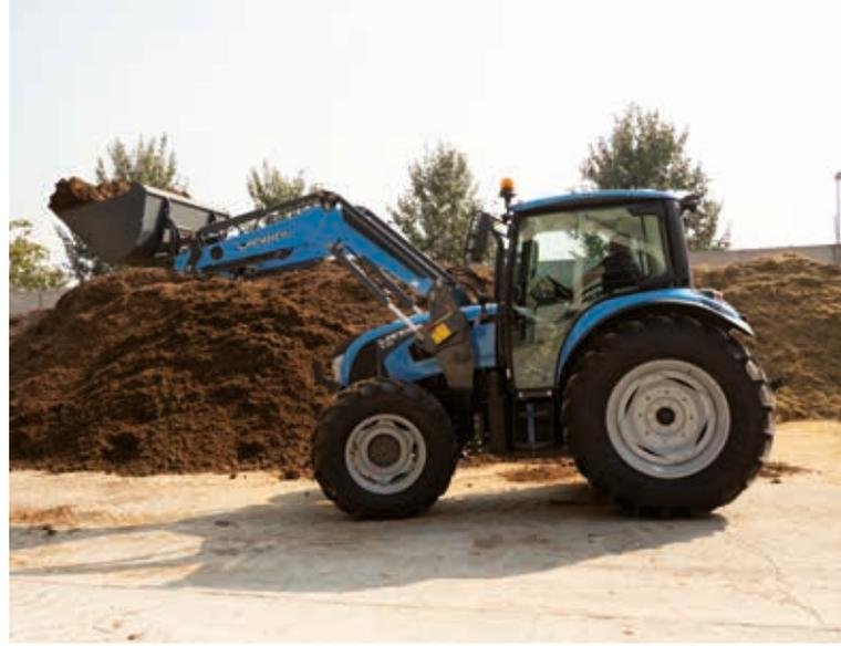
La **Serie 5** posee un potente sistema hidráulico de 62 l/min y un elevador trasero que proporciona una capacidad de elevación de 4500 kg y puede equiparse de forma opcional con sistema de control ELS (Ergonomic Lift System). Gracias a su tamaño compacto (distancia entre ejes 2,36m), a un peso de 3800 kg y a unos neumáticos traseros de 34", el tractor **Serie 5** resulta ideal para todas las actividades agrícolas, incluso con el cargador frontal (en opción).
