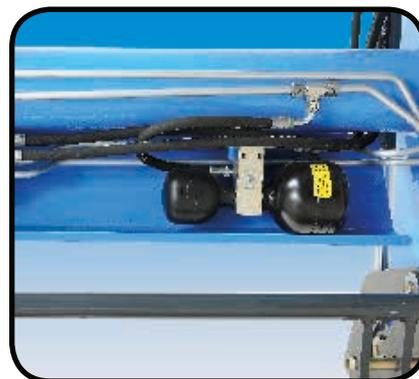
Los cilindros de elevación cuentan con dos acumuladores de nitrógeno que amortiguan los impactos y las oscilaciones garantizando así una conducción más suave y confortable (fig. C).
