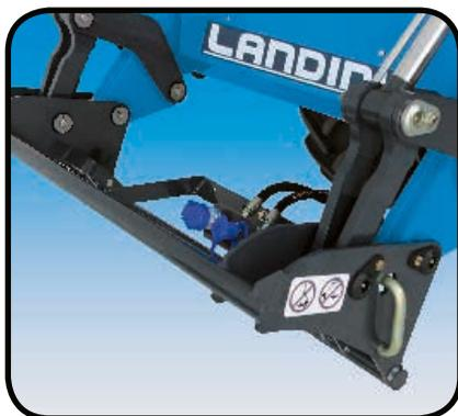
En la parte delantera de la pala puede instalarse de forma opcional una electroválvula de dos vías para accionar los cilindros de los implementos que disponen de funciones hidráulicas adicionales (fig. B).
