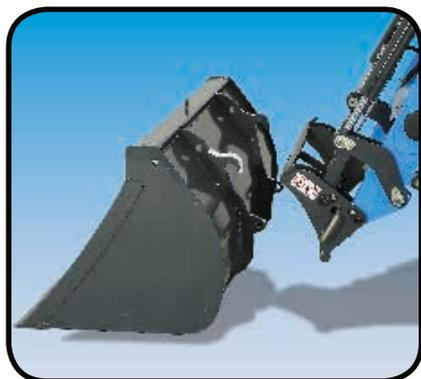
Las palas frontales Landini equipan un enganche rápido de tipo Euro que permite utilizar una amplia gama de implementos (fig. A).
