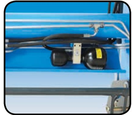
Les vérins de levage sont pourvus de boules d'azote qui permettent d'absorber les chocs dus aux irrégularités du terrain en améliorant le confort de conduite (fig. C).
