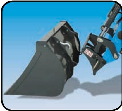
Les chargeurs Landini sont équipés de série d'un porte-outil Euro qui permet d'utiliser une vaste gamme d'outils (fig. A).
