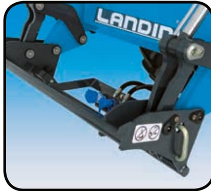
En option, une électrovanne à deux voies peut être installée à l'avant du chargeur pour actionner les vérins des outils disposant de fonctions hydrauliques supplémentaires (fig. B).
