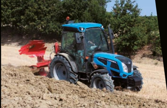
Alle Modelle der Reihe sind mit 24- und 28-Zoll-Hinterreifen erhältlich. Zusätzlich kann die Version GT mit 30-Zoll-Bereifung ausgestattet werden, was dieses Modell sowohl für Obstplantagen mit breitem Reihenabstand als auch bei Feldarbeit und Transport ideal geeignet macht.
