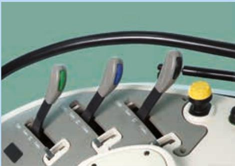
El tractor **Serie 5** puede equipar hasta cinco distribuidores hidráulicos. De éstos, tres son accionados por palancas integradas en la consola a la derecha del conductor. Dos distribuidores ventrales están disponibles como opción para accionar otros aperos, como p.ej. el cargador frontal serie M. Los distribuidores son de cuatro tipos y pueden combinarse entre ellos para satisfacer diferentes necesidades de aplicación:
