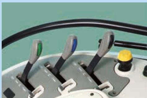
Fino a 5 distributori idraulici possono ampliare la dotazione del **Serie 5**; di questi, 3 sono controllati da leve meccaniche poste sulla consolle a destra del conducente. A richiesta, sono disponibili 2 ulteriori distributori ventrali, per collegare altri attrezzi, come il caricatore frontale Serie L. I distributori supplementari sono di 4 tipi, combinabili tra loro in base alle diverse esigenze di lavoro:
