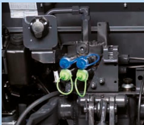
Ogni opzione permette di lavorare con il sollevatore e il caricatore anteriori, con il sollevatore posteriore e con gli attrezzi collegati, garantendo così la massima efficienza. In più, gli attacchi rapidi dei distributori, di alta qualità e comodamente sistemati sul lato posteriore e anteriore del trattore, grazie ai facili innesti delle linee idrauliche permettono un grande risparmio di tempo.
