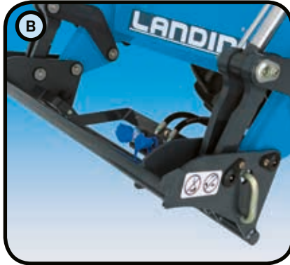
Optional kann ein Umschaltventil mit zwei Hydraulikanschlüssen an der Vorderseite des Frontladers installiert werden, um die Zylinder der Werkzeuge, die über hydraulische Zusatzfunktionen verfügen, zu betätigen (Abb. B).
