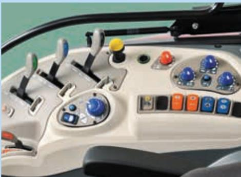
Der **6H** kann auf Wunsch mit bis zu vier Steuerventilen ausgestattet werden. Drei der Ventile werden mechanisch über Hebel betätigt und eines wird elektrohydraulisch über eine Drucktaste gesteuert. Für die Verwendung von Frontladern der L-Serie oder anderen Frontanbaugeräten sind zwei zusätzliche Zwischenachssteuergeräte erhältlich. Es stehen vier Arten von Steuerventilen zur Verfügung, die für unterschiedliche Anwendungen kombiniert werden können:
