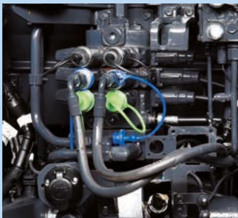
Jede der Hydraulikoptionen ermöglicht das Arbeiten mit dem Frontkraftheber, dem Frontlader und einer Vielzahl an Anbaugeräten, die die Effizienz und Produktivität steigern. Hochwertige Schnellkupplungen sowohl vorne als auch hinten am Traktor ermöglichen das schnelle und einfache An- und Abkuppeln von Hydraulikleitungen, sodass Sie keine Zeit verlieren.
