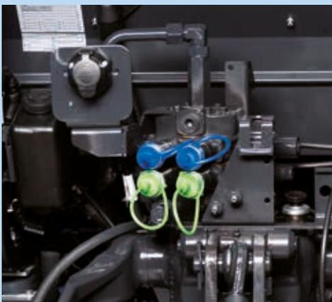
Die **Serie 5** kann mit bis zu fünf Steuergeräte ausgestattet werden. Drei Steuergeräte werden mechanisch über Hebel betätigt, die in der rechten Konsole integriert sind. Für die Verwendung von Frontladern der L-Serie oder anderen Frontanbaugeräten ist ein Einhebelsteuergerät in der Kabine verfügbar. Es stehen vier Arten von Steuergeräten zur Verfügung, die für unterschiedliche Anwendungen kombiniert werden können:
