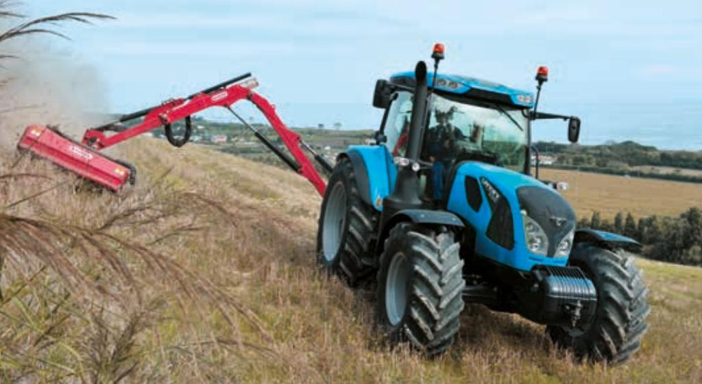
La nuova serie Landini 6C è disponibile nei tre modelli da 114, 121 e 130 CV, con i nuovi motori FPT-NEF da 4,5 litri, dotati del nuovo sistema (Selective Catalytic Reduction) SCR + DOC (Diesel Oxidation Cathalizer) per rispondere alla normativa Tier4 Final. Dotati di Dual Power i motori innalzano sensibilmente i livelli di potenza massima disponibile rispettivamente a 121, 133 e 140 CV per l'utilizzo della PTO e in trasporto.
