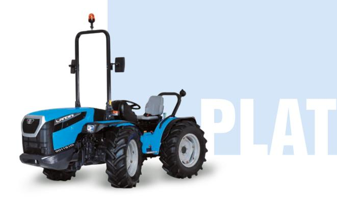
Die beiden Modelle der Baureihe verfügen serienmäßig über ein Schaltgetriebe mit mechanischer Wendeschaltung und Kriechganggetriebe, das 16 Vorwärts- und 16 Rückwärtsgänge zur Verfügung stellt.
