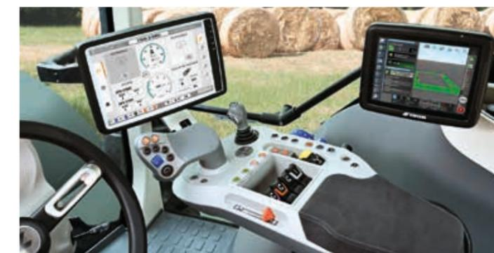
L'allestimento **Dynamic** è equipaggiato di serie con il bracciolo multifunzione. Tutti i suoi comandi sono stati attentamente posizionati per favorire la massima ergonomia, come quelli della trasmissione Robo-Six e quelli dei distributori idraulici a controllo elettronico.
