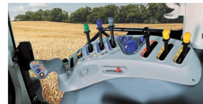
Tutti i comandi dell'allestimento **Active**, come quelli della trasmissione Robo-Six e quelli dei distributori idraulici a controllo meccanico, sono disposti in modo ergonomico sulla plancia destra, per favorire il massimo comfort di lavoro.
