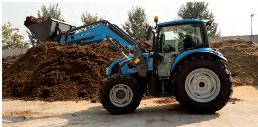
è controllabile dall'ELS (Ergonomic Lift System) ed offre una capacità di sollevamento di 4500 Kg.
