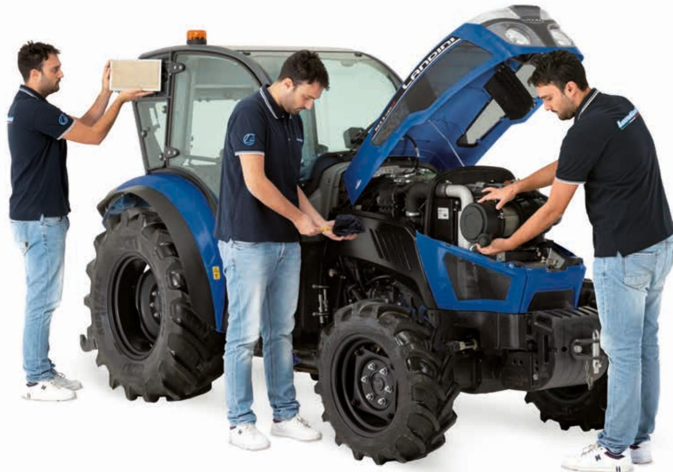
Diseñados para garantizar una fiabilidad total y un rendimiento óptimo, los tractores de la serie **REX3** ofrecen una variedad de soluciones técnicas que facilitan y agilizan el mantenimiento del tractor. El capó con apertura basculante total y los paneles laterales amovibles facilitan el acceso al motor agilizando las tareas de mantenimiento.
