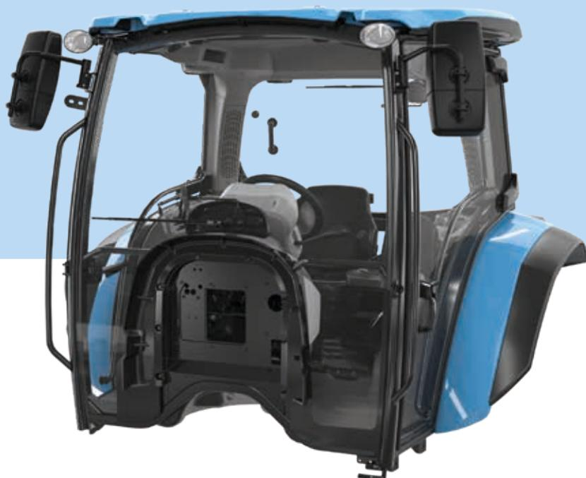
tramite prove FOPS (*Falling Objects Protecting Structure*) la cabina è stata omologata per l'utilizzo del caricatore frontale.
