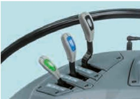
Der **Serie 4** kann mit bis zu fünf hydraulischen Steuergeräten, drei im Heck und zwei im Zwischenachsbereich, ausgestattet werden. Die mittig angebrachten Steuergeräte werden über einen Hebel betätigt und ermöglichen die Verwendung eines Frontkrafthebers oder eines Frontladers. Es stehen vier Arten von Steuergeräten zur Verfügung, die für unterschiedliche Anwendungen kombiniert werden können:
