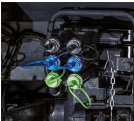
Jede dieser Optionen ermöglicht es, den Traktor mit einer Vielzahl von Anbaugeräten einzusetzen, um Effizienz und Produktivität zu verbessern. Ergonomisch angeordnete hochwertige Schnellkupplungen ermöglichen das schnelle und einfache An- und Abkuppeln von Hydraulikleitungen.
