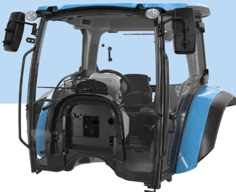
De plus, pour garantir le maximum de la sécurité, par le biais de tests FOPS (*Falling Objects Protecting Structure*), la cabine a été homologuée pour l'utilisation du chargeur frontal.
