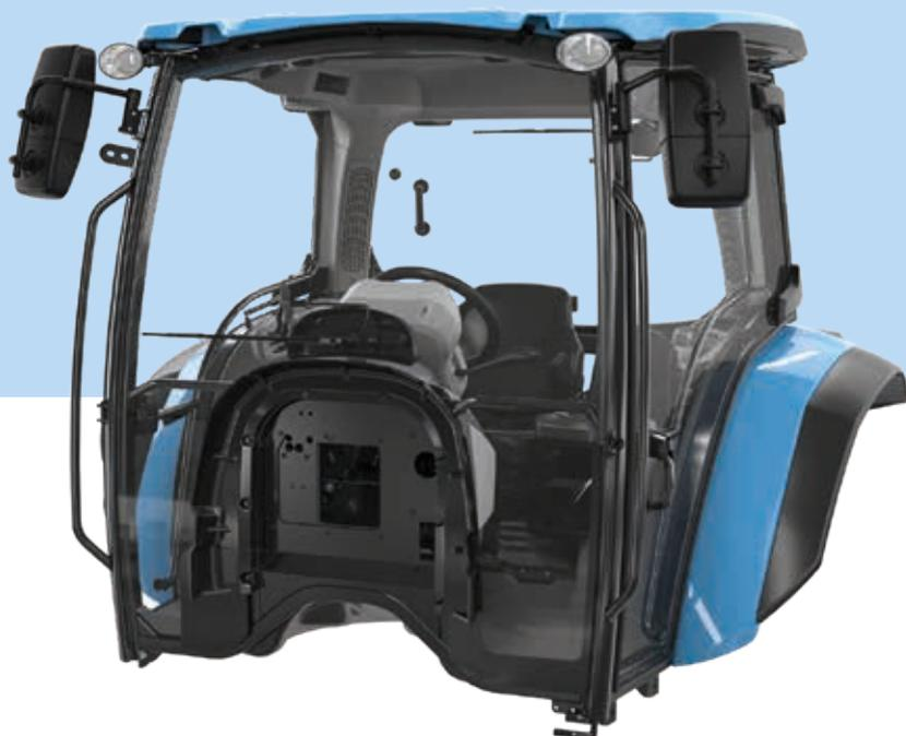
agiliza el trabajo con la pala cargadora frontal. La cabina Total View Slim cuenta con una estructura de protección FOPS contra la caída de objetos y está homologada para trabajar con palas cargadoras frontales. El **Serie 4** puede equiparse con unos neumáticos estrechos que permiten reducir el ancho mínimo hasta 1820 mm, convirtiendo este tractor en ideal para trabajar entre las estrechas hileras de árboles frutales.
