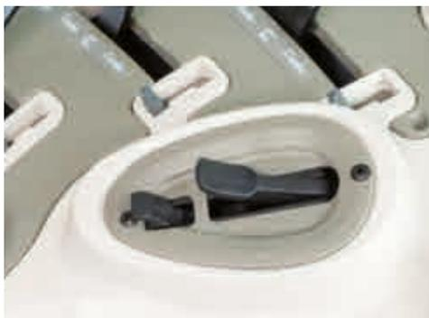
La prise de force a 540 tours. Sur demande, elle peut comporter 4 vitesses : 540 / 540E / 1000 / 1000E tours. L'embrayage à commande hydraulique, avec disques à bain d'huile, engage progressivement la prise de force pour des passages en douceur et éviter des actionnements brusques de l'arbre. Pour faciliter la fixation des outils, la prise de force est dotée de commandes sur les garde-boues arrière
