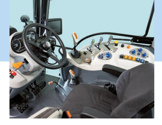
El diseño de 4 montantes de la cabina maximiza el acristalamiento para proporcionar un campo de visión panorámico de 360° y facilitar el trabajo en espacios reducidos donde se necesita una excelente visibilidad de corto alcance. Hasta 10 luces LED iluminan perfectamente el área durante el trabajo nocturno. La ventanilla transparente en el techo garantiza una visión completa durante el uso de la pala cargadora delantera.
