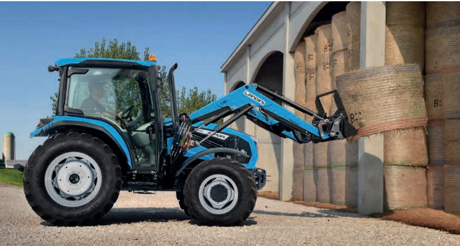
Graças a um joystick convenientemente localizado e uma escotilha de teto transparente de alta visibilidade, o operador pode sentar-se confortavelmente na posição de condução enquanto trabalha com o carregador totalmente levantado. Projetado para ser a combinação perfeita para o trator **Serie 4**, o carregador frontal Landini oferece o máximo de produtividade em qualquer aplicação.
