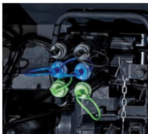
A **Serie 4** pode ser equipada com até distribuidores hidráulicos, três montadas na parte traseira e dois ventrais. Os controlos remotos ventrais, operados por um joystick, permitem o uso de um engate frontal ou de um carregador frontal.
