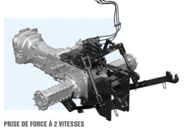
La prise de force a 2 vitesses : 540 / 540E tr/min et vitesse synchronisée à la transmission. Un bouton permet d'engager la PDF avec un maximum de progressivité, pour un engagement souple et progressif dans toutes les conditions de fonctionnement et avec tout type d'outil.
