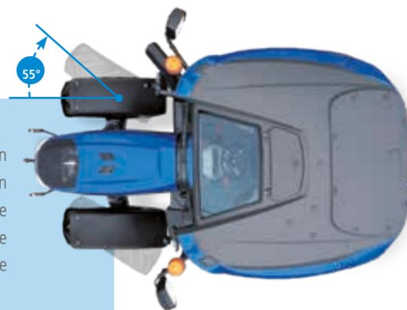
La maniobrabilidad y la precisión se garantizan también por la amplia oscilación del eje, la gran distancia hasta el suelo y un ángulo de dirección de 55°. La conducción hidroestática también permite un viraje suave incluso a bajas revoluciones. El eje suspendido permite alcanzar los 50 km/h.
