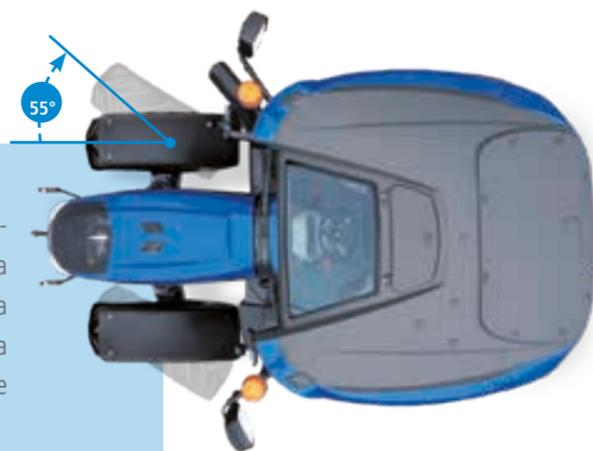
Manovrabilità e precisione vengono anche dall'ampia oscillazione dell'assale, dall'alta luce libera da terra e da un angolo di sterzo fino a 55°. La guida idrostatica consente poi una sterzata dolce anche a bassi regimi. L'assale sospeso permette di arrivare a 50 km/h.
